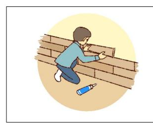
はく離紙を引き抜いたら、施工面(壁・ 天井) に押し付け固定する。
