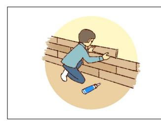
モザイク eco ウォールのサネを合わせて、 455mm 間隔を目安に、釘(ステープルまた はスクリューネイル)で固定する。 季節に合わせて、適度な隙間(エキスパン ション)を確保する。
